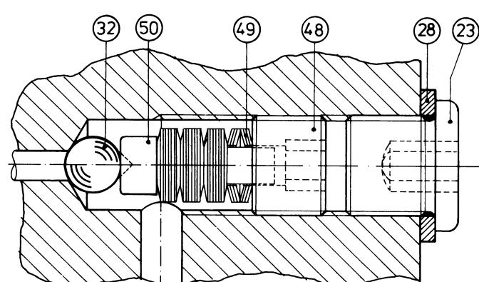
**NL** DETAILTEKENING OVERDRUKBEVEILIGING VAN ELECTRO-HYDRAULISCHE POMPEN.
